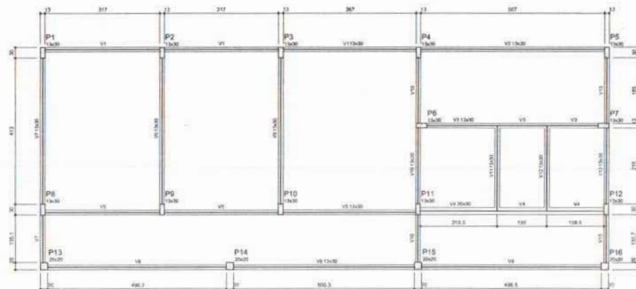
2 FORMA DO PAVIMENTO NÍVEL 000 ESCALA: 1/50
